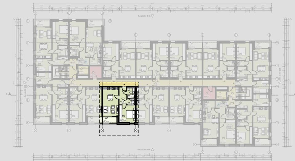
**Grundriss** | 1. Obergeschoss - Mustereinheiten 1-Zimmer, M 1:100
